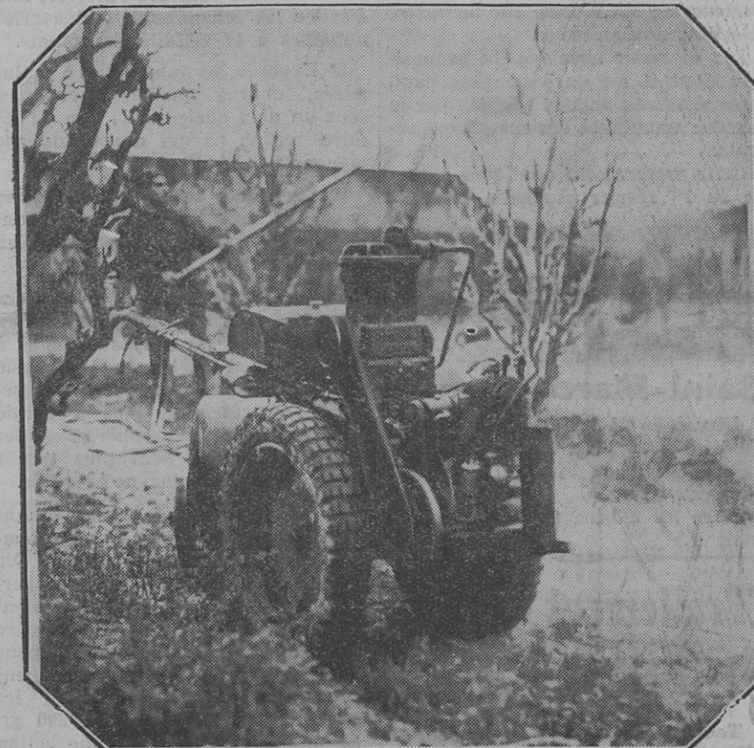
Un pulvérisateur à haute puissance « Mesbla » traitant des pommiers avec une solution d'huile d'antracène émulsionnée.
