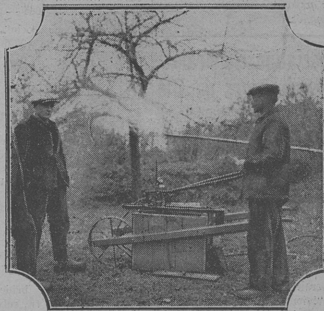
Pompe « Fortuna » montée sur brouette à caisse
